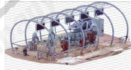
Point cloud ช่วยให้งานออกแบบ Line ง่ายและแม่นยำมากขึ้น
