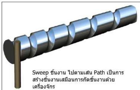
Sweep ชั้นงาน ไปตามเส้น Path เป็นการสร้างชั้นงานเมื่อมีการกดชั้นงานด้วยเครื่องจักร
